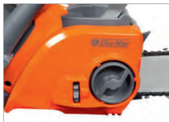
Szerszám nélküli láncállítás.
